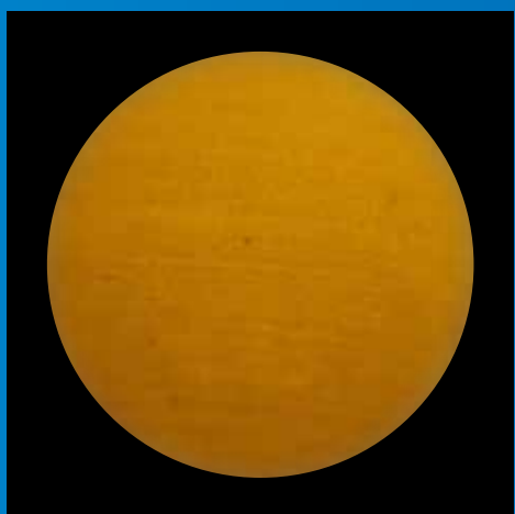
Microscopisch beeld van een SBS bitumen die perfect homogeen is
